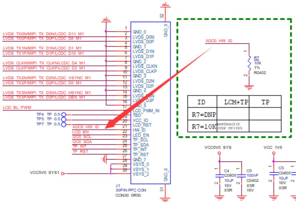
不同的 mipi 屏会配置不同的阻值，配合 EVB 主板确定一个唯一的 ADC 参数值。
