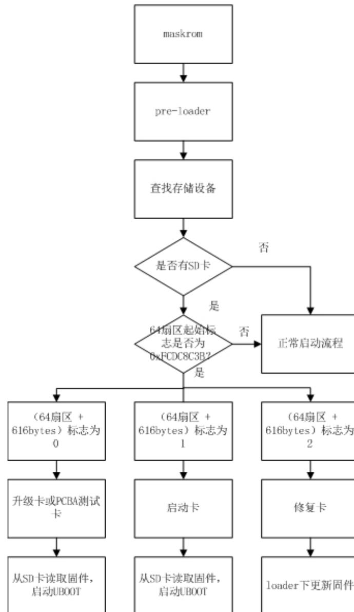
maskrom 首先找到一份可用的 miniloader 固件（可以从 TRM 确定 Maskrom 支持的启动存储介质和优先顺序，maskrom 会依次扫描可用存储里的固件），然后跳转到 miniloader。miniloader 重新查找存储设备，如果检测到 SD 卡，检测 SD 卡是否包含 IDB 格式固件。如果是，再判断卡标志。如果 SD 卡可用且标志位为 '0' 或 '1'，则从 SD 卡内读取 U-Boot 固件，加载启动 U-Boot。如果标志为 '2'，则进入修复卡流程，在 loader 下更新固件。正常启动流程为扫描其他存储，加载启动下级 loader。
