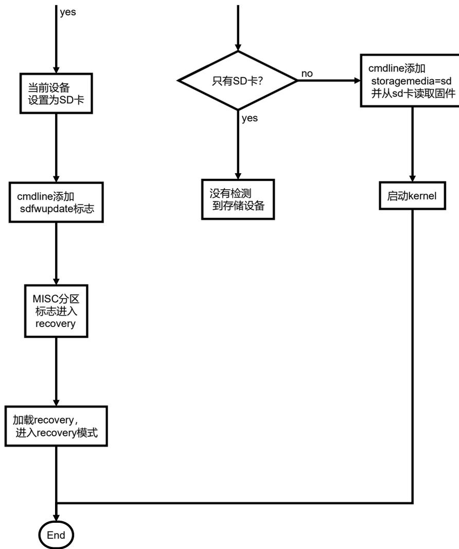
升级卡：U-Boot 重新查找存储设备，如果检测到 SD 卡，检测 SD 卡是否包含 IDB 格式固件。如果是，再判断偏卡标志是否为 0，传递给 kernel 的 cmdline 添加'sdfwupdate'。最后读取 SD 卡的 misc 分区，读取卡启动模式，若为 recovery 模式，加载启动 recovery。
