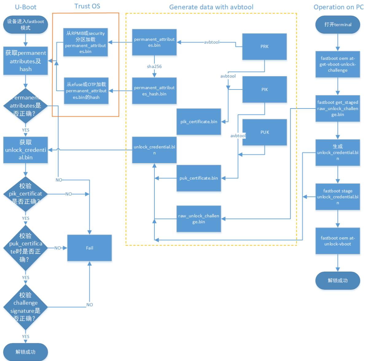
最后 efuse 设备解锁流程:
