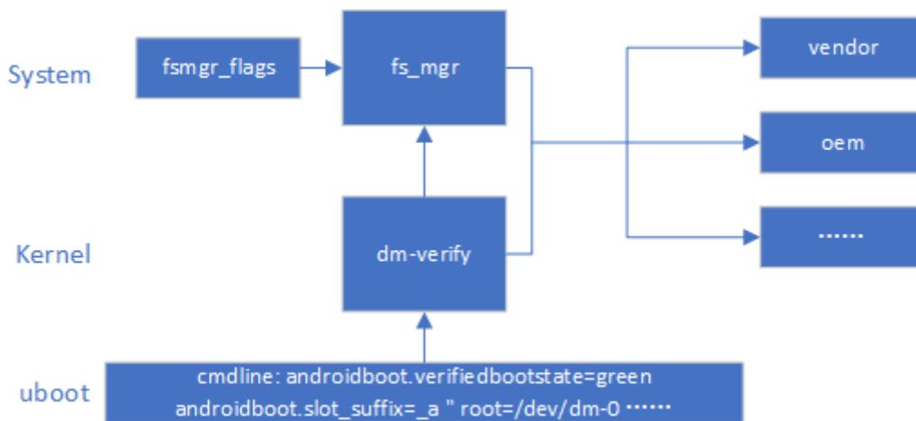
系统启动到 kernel，kernel 首先解析 U-Boot 传递的 cmdline 参数，确认系统启动是否使用 dm-verify。然后加载启用 system 的 fs\_mgr 服务。fs\_mgr 依据 fsmgr\_flags 的参数来校验加载固件，固件 hash & hash tree 存放于 vbmeta.img。主要有如下参数：
