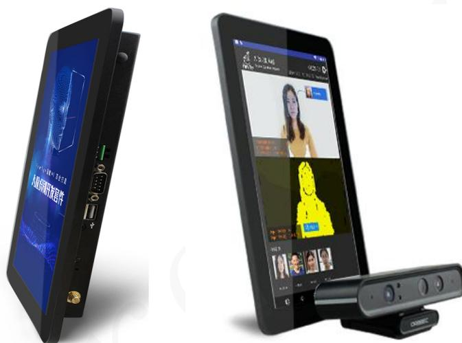
人脸识别开发套件由高性能 **RK3399 主控的行业主板 AIO-3399C、工业级的宽动态摄像头模组、10.1 寸高清显示屏**以及**百度人脸识别全功能集的离线 SDK 组成**。
